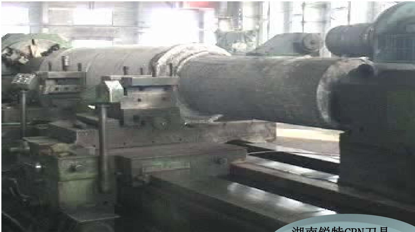
加工材料：铸态高镍铬；硬度：HSD80（HRC60）
