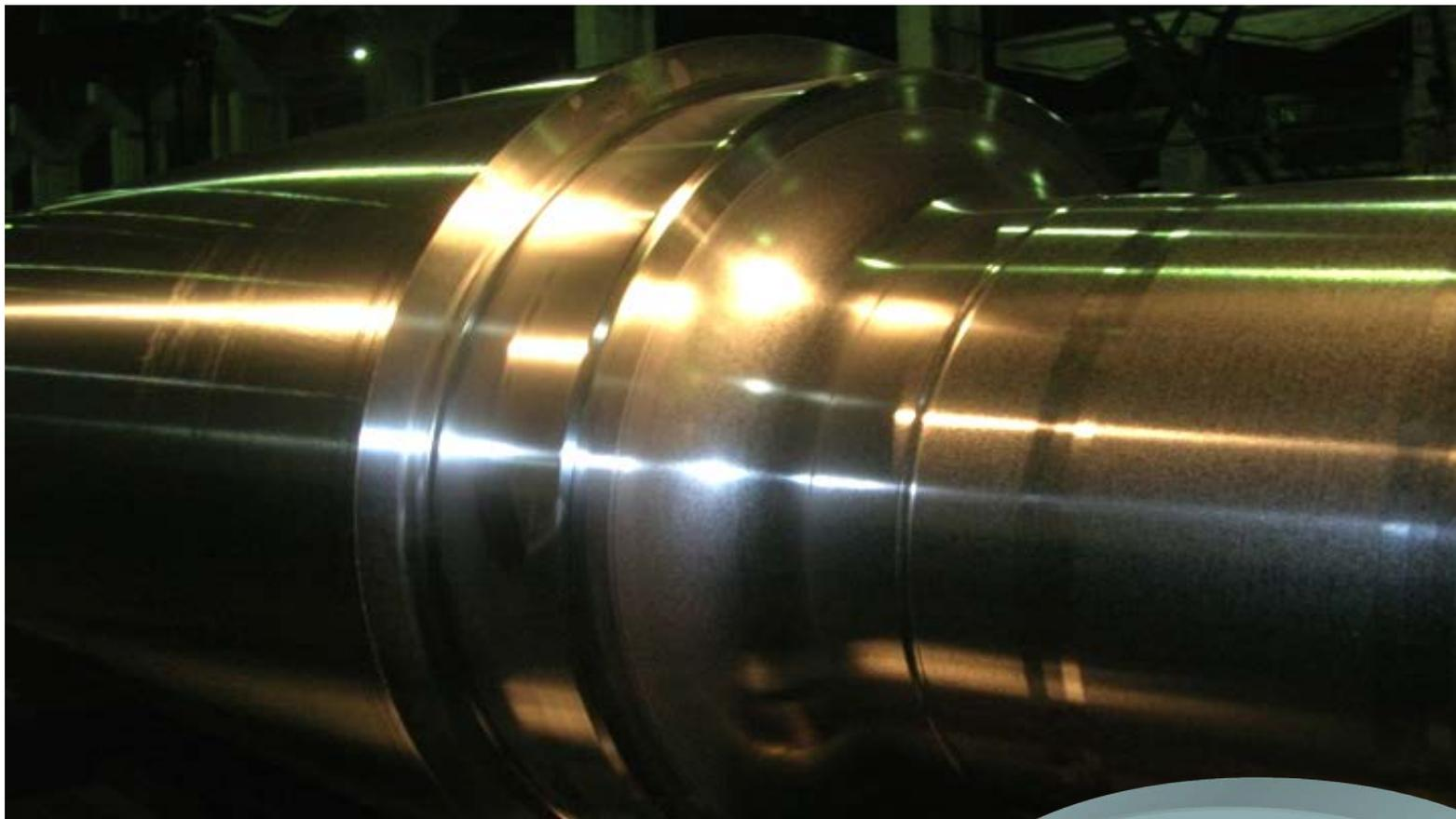
加工材料：高镍铬铸铁；硬度：HSD63（HRC47）
