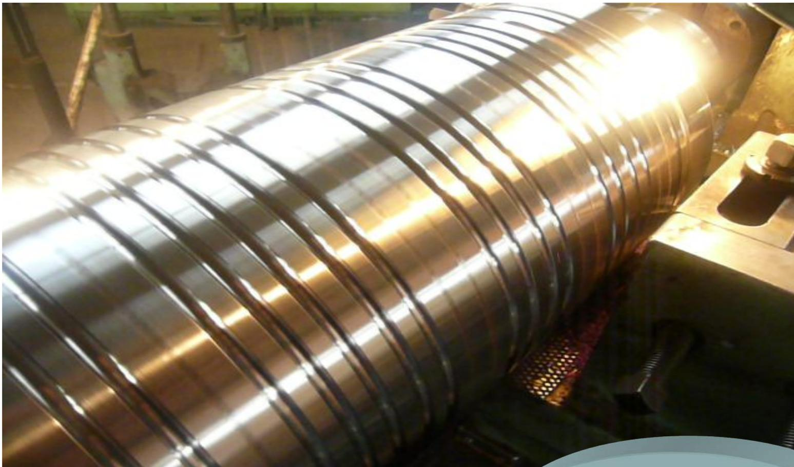
加工材料：合金无限冷硬铸铁；硬度：HSD68
